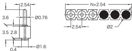
■自己調整浮動コンタクトで基板の凸凹に合わせて実装出来ます
