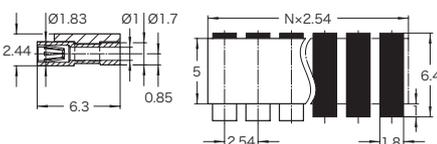
■ソケットピンのみを基板に平行に実装します。キャリアは実装後取り除きます    ※xxxにピン数を入れて下さい。2~10ピン
