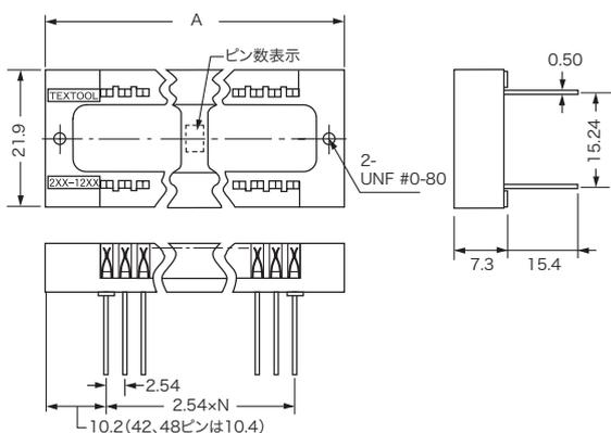
●固定用耳付レセプタクル(600mil用、ダブルタイプ)寸法図
