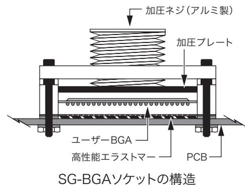
■アイアンウッド社のGHz BGAソケットはBGAデバイスを使用した試作、試験用に最適な製品です。このシリーズはハンダ付け不要で最高の周波数特性を發揮しコスト以上のパフォーマンスをもたらしてくれます
