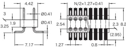
■2列の間隔が2.54mmのハーフピッチの表面実装ダブル・インライン・ピンコネクタで基板に対し垂直に実装されます ※xxxにピン数を入れて下さい。4~100ピン
