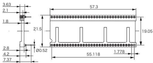
■各種シュリンクパッケージ(1.778mmピッチ)に対応した丸ピンDIPソケット。16~64ピンに対応。振動・衝撃にも強い4枚羽の高信頼性ソケットです
