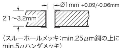
(スルーホールメッキ: min.25 $\mu\text{m}$ 銅の上に min.5 $\mu\text{m}$ ハンダメッキ)
