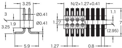
■ハーフピッチの表面実装ダブル・インライン・ピンコネクタで、基板に対し垂直に実装されます ※xxxにピン数を入れて下さい。4~100ピン
